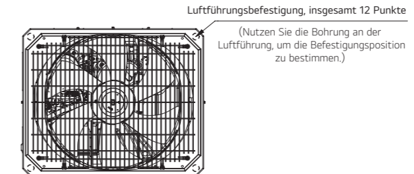
Luftführungsbefestigung, insgesamt 12 Punkte
