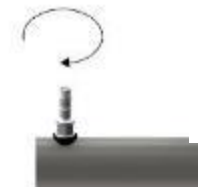
3. Ablaufstutzen mit Schraubenschlüssel festziehen
