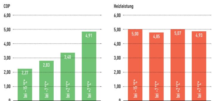
\* Wasservorlauftemperatur 35°C, Außentemperatur 7°C
