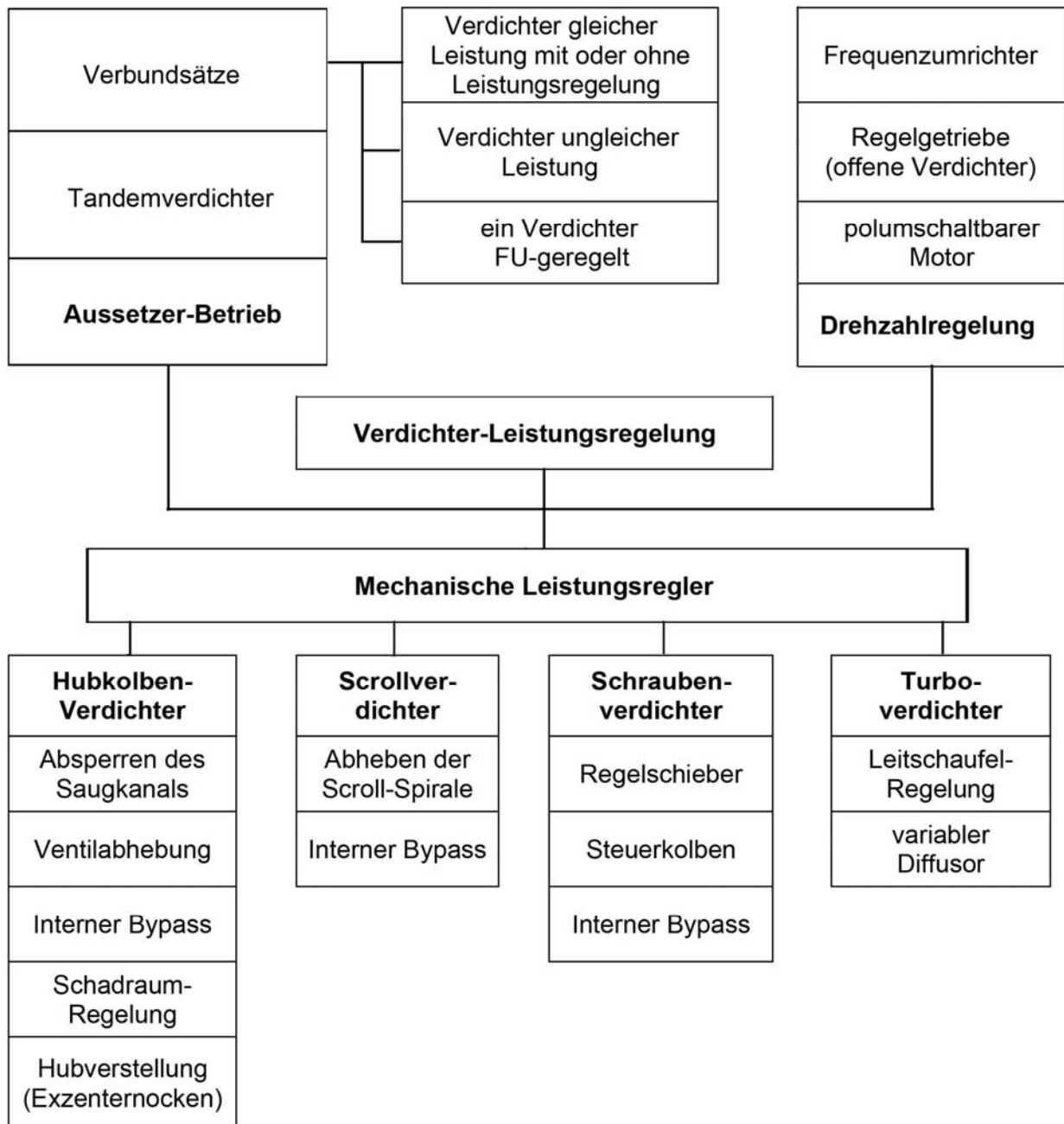
Bild 9: Leistungsregelung von Verdichtern
