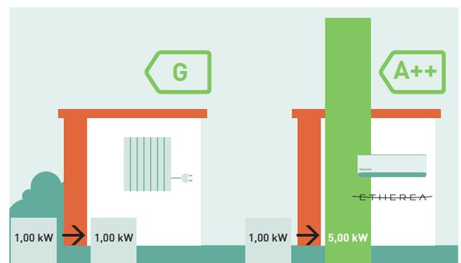
Vergleich von N225YKE und N235YKE bei Heizbetrieb mit einer Elektroheizung bei  $+7^{\circ}\text{C}$  Außentemperatur.
