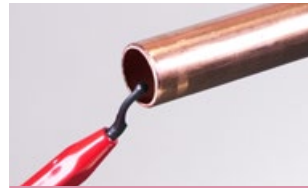
3. Rohr innen und außen entgraten
