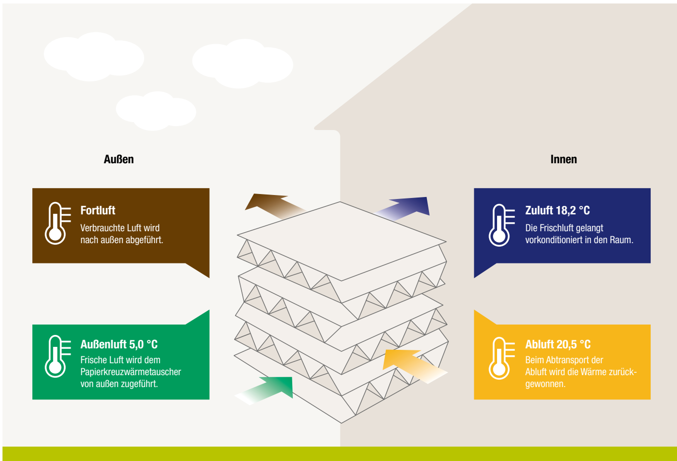
Struktur und Funktion des Papierkreuzwärmetauschers, Berechnungsbeispiel mit VL-50(E)S2-E bei niedriger Lüfterstufe in 230 V/50 Hz: 18,2\text{ °C} = (20,5\text{ °C} - 5\text{ °C}) \times 85\% \div 5\text{ °C}
