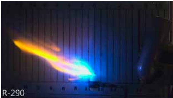
Abbildung 3 – Bestimmung der Flammenlänge (gem. ASTM D3065) an R-290
