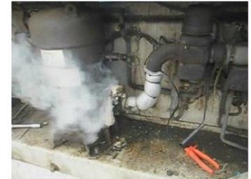
Öffnen des Hochdruckventils – sofortige Flüssigkeitszündung
