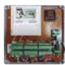
Steuereinheit mit Platine, Transformator und Klemmenblöcken
